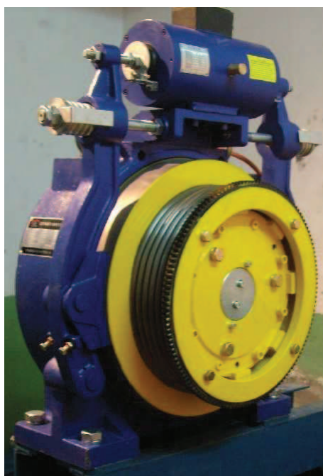
Рис. 2. Привод лифта (лебедка).
